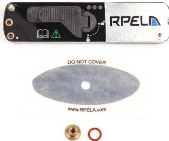
**Figure 7.** Boîtier du Rpela version 2 – Haut : boîtier de puissance avec électrode en aluminium sur sa partie droite de la photo – Bas : autocollant additionnel de l'électrode avant.
