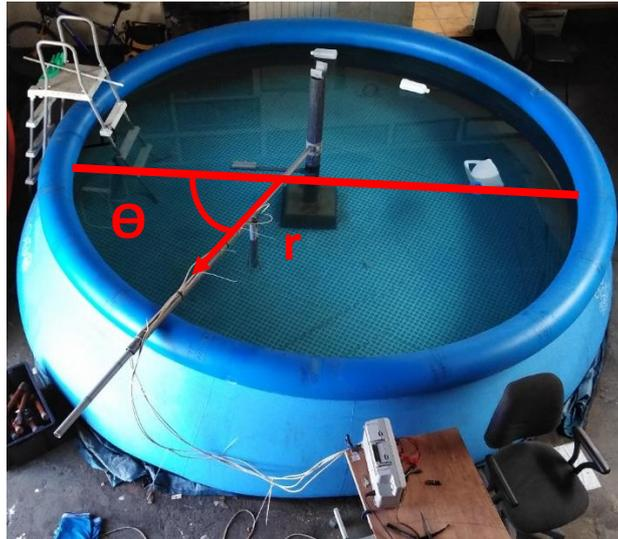
Figure 13 : Système de positionnement polaire dans le bassin d'essai du CRA
