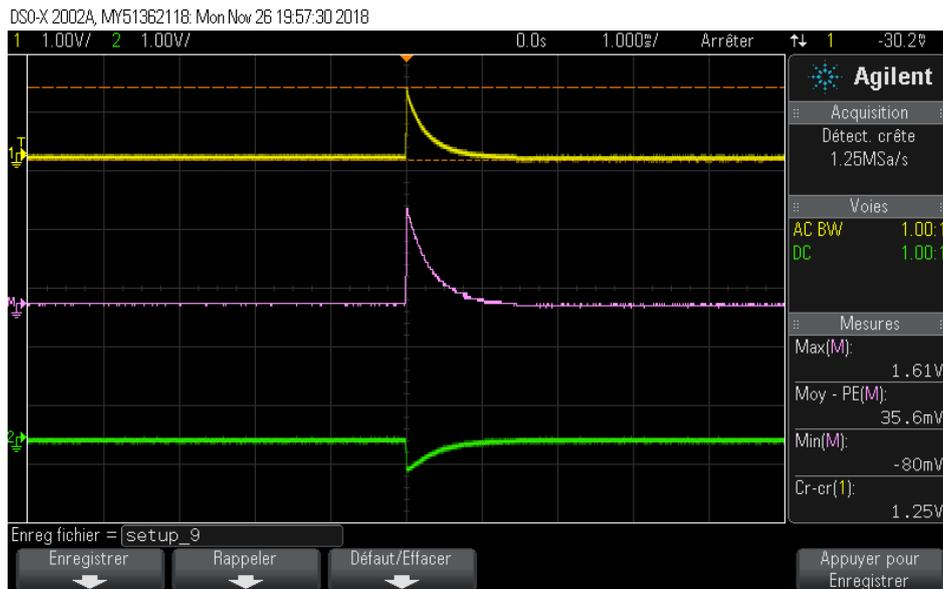
Figure 24 : Forme d'une impulsion du SHARKSHIELD – FREEDOM + SURF – Courbe rose : signal du champ électrique mesuré entre les deux électrodes de la platine (signaux jaunes et verts)
