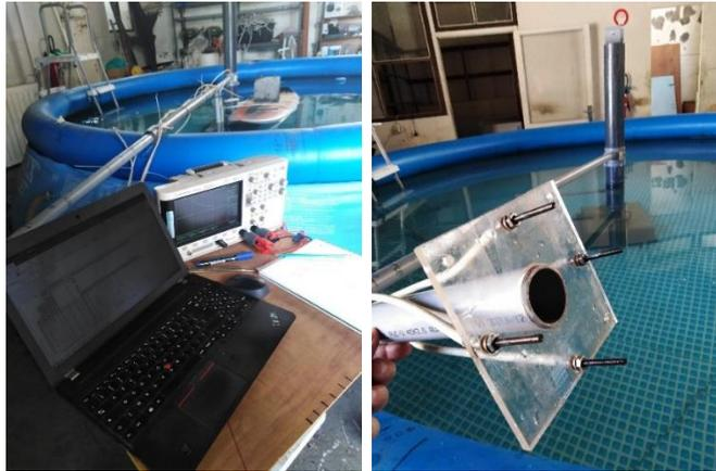
Figure 12 : Bassin expérimental du CRA pour les tests des EPI (Bassin ; PC/oscilloscope ; Electrodes de mesure)
