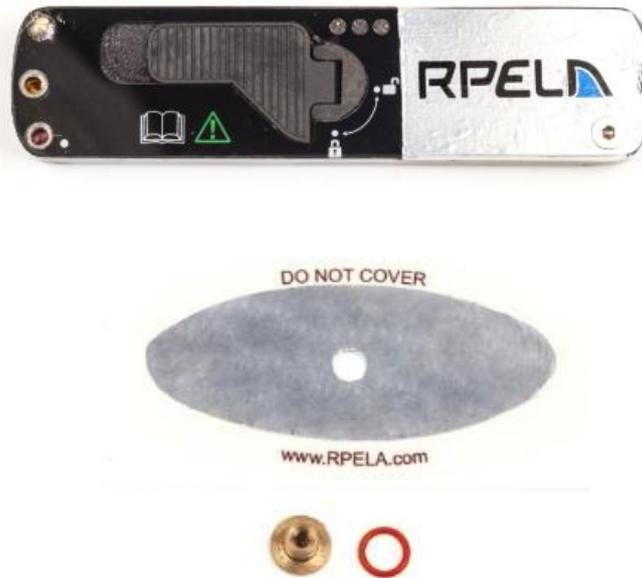
*Figure 7 : Boitier du Rpela version 2 – Haut : boitier de puissance avec électrode en aluminium sur sa partie droite de la photo – Bas : autocollant additionnel de l'électrode avant*
