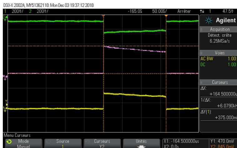
Figure 20 : Forme d'une impulsion du NoShark – Courbe rose : signal du champ électrique mesuré entre les deux électrodes de la platine (signaux jaunes et verts)
