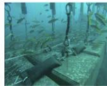
FIGURE 78: ILLUSTRATION REPRESENTATIVE DE LA STRUCTURE DU SYSTEME SSB ® , ORIENTATION DES ANGLES ET PHOTOGRAPHIE DES AIMANTS D'ANCRAGE. LA RANGEE EXTERNE EST COMPOSEE DE 100 UNITES FONCTIONNELLES (2 COTES DE 27 UNITES ET 2 COTES DE 23 UNITES) ; LA RANGEE INTERMEDIAIRE EST COMPOSEE DE 56 UNITES FONCTIONNELLES ET LA RANGEE INTERNE EST COMPOSEE DE 44 UNITES FONCTIONNELLES. CHAQUE UNITE FONCTIONNELLE EST COMPOSEE D'UN BLOC ET D'UN TUBE, ET AU NIVEAU DE LA RANGEE EXTERNE, DES AIMANTS ADDITIONNELS SONT DISPOSES SUR LES BLOCS. (RAPPORT TECHNIQUE SHARKSAFE BARRIER EN BAIE DE ST-PAUL, REUNION)
