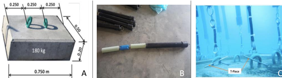
FIGURE 89: DIFFERENTS COMPOSANTS D'UNE UNITE FONCTIONNELLE. (A) POIDS ET DIMENSION D'UN BLOC D'ENCRAGE ; (B) PHOTOGRAPHIE D'UN TUBE EN PEHD, COMPOSE DE MOUSSE ET D'UN AIMANT (EN BLEU) ; (C) PHOTOGRAPHIE D'UNE « PIECE EN T » RATTACHANT LES DEUX ELEMENTS PRECEDENTS (RAPPORT TECHNIQUE SHARKSAFE BARRIER EN BAIE DE ST-PAUL, REUNION).
