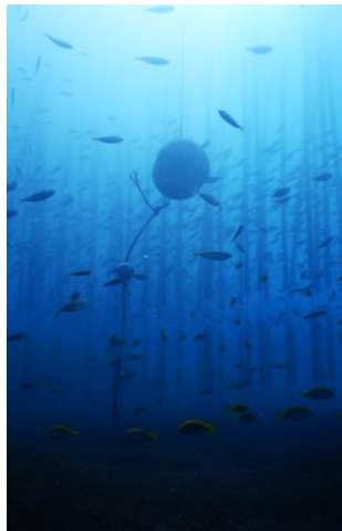
FIGURE G : PHOTOGRAPHIE DE LA CAGE CONTENANT LA MATIÈRE ORGANIQUE POUR CRÉER UN STIMULI OLFACTIF (N. CHABRIER, 25.04.19). LA CAGE EST MAINTENUE ENTRE UN CORPS-MORT ET UNE BOUÉE DE SURFACE ET ONDULE AVEC LA HOULE.
